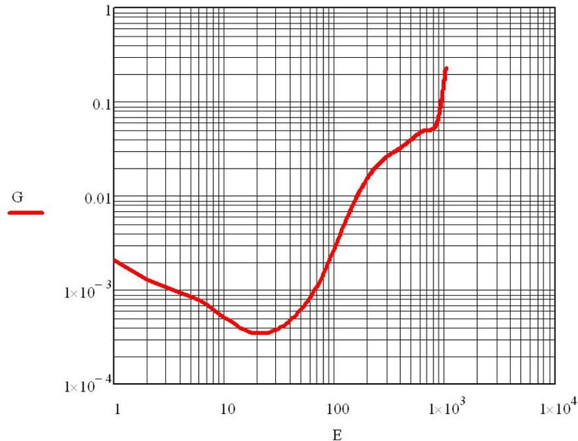
Функция преобразования  $G(E)$  БДКГ-03М для измерения мощности кермы в воздухе.
