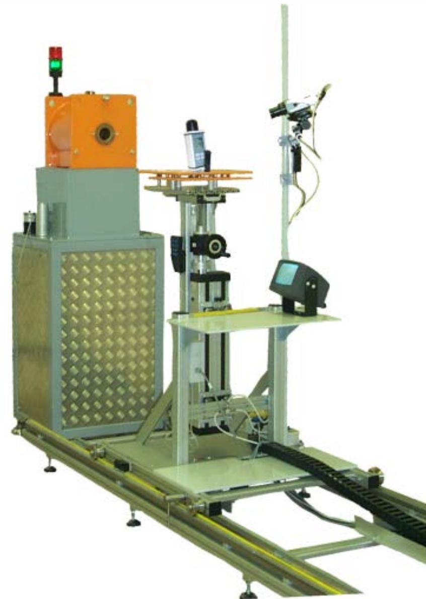
Дозиметрические установки гамма-излучения УДГ-АТ110, УДГ-АТ130:
