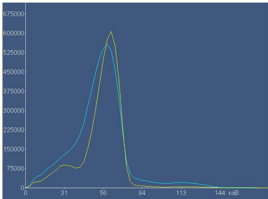
Результаты исследования линейной зависимости чувствительности БДМГ-АТ1106 с оконной функцией отклика G(E) на рентгеновской линии L70 (61 кэВ)
