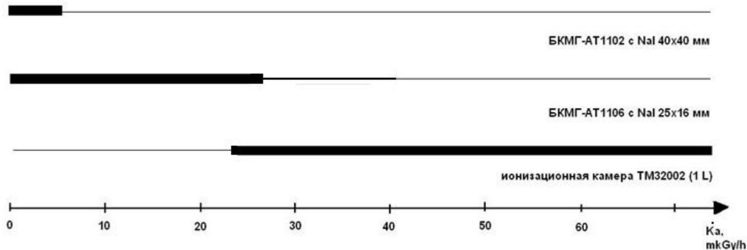
Области перекрытия диапазонов измерения мощности кермы в воздухе для блоков-компараторов (диапазон энергий 40 – 300 кэВ) и ионизационной камеры ТМ32002 РТW (V= 1 л)
